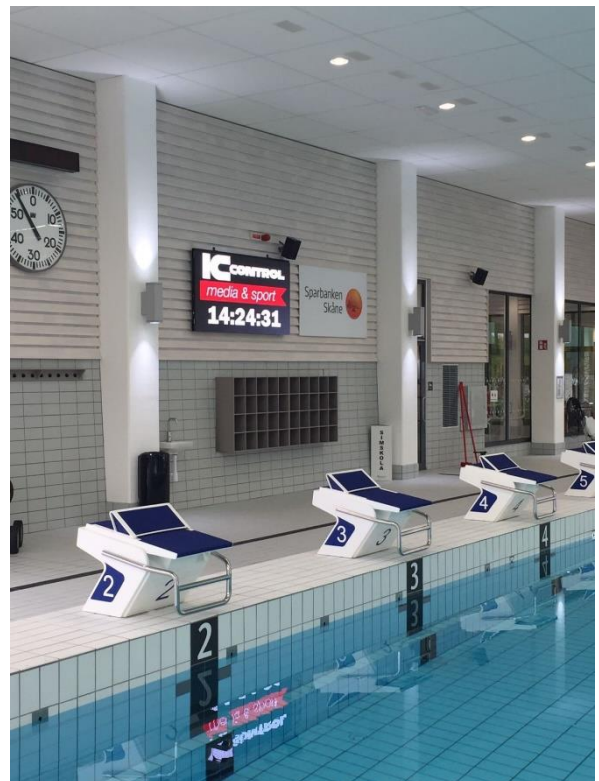
Exempel Sjöbo simhall, 2m 2 P 6,94mm Videotavla fix på vägginstallation 2016
